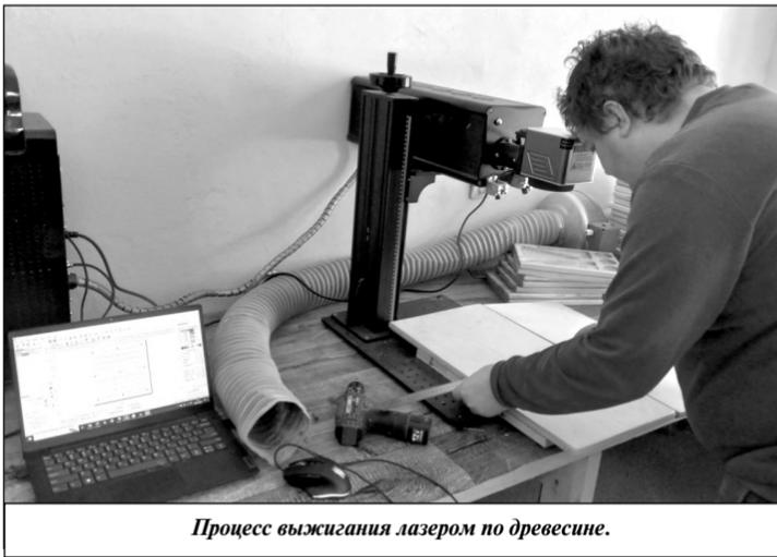
Процесс выжигания лазером по древесине.
