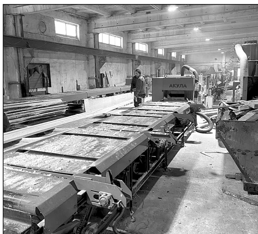
Цех по глубокой переработке древесины. Многопильный современный дисковый станок «АКУЛА», позволяющий проводить глубокую переработку древесины.
